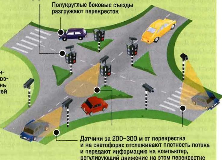
Датчики за 200–300 м от перекрестка и на светофорах отслеживают плотность потока и передают информацию на компьютер, регулирующий движение на этом перекрестке
